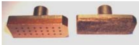
図1: 銅-タングステン接触子の磨耗
