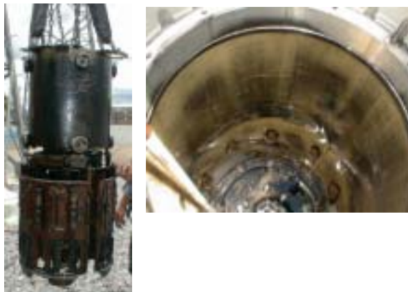
図2: ダイバータスイッチインサートと油槽の炭素堆積物
